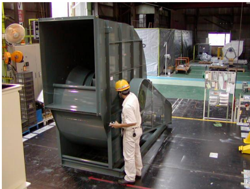
▲送風機組立工程
