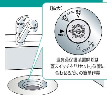
過負荷保護装置解除は蓋スイッチを「リセット」位置に合わせるだけの簡単作業
