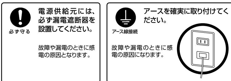
※漏電遮断器・アース工事は、電気工事店に依頼してください。(有料)
