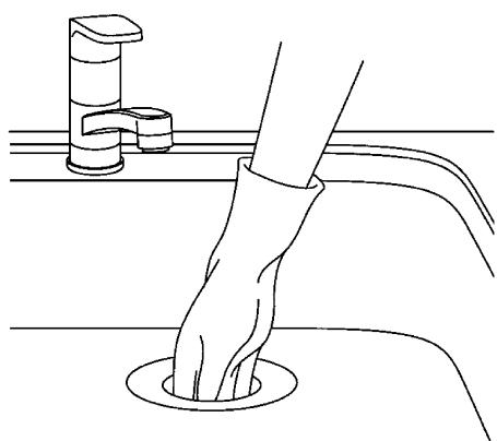
厚手のゴム手袋などをして、投入口に手を入れて破碎室内部の生ごみをできるだけ取り出してください。
