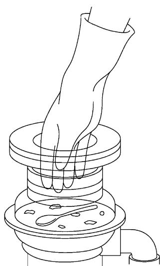
ディスポーザの破碎室内部の異物を取
