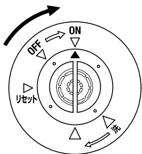
投入口に蓋スイッチを挿入して右に回し、ディスポーザが運転することを確認してください。
